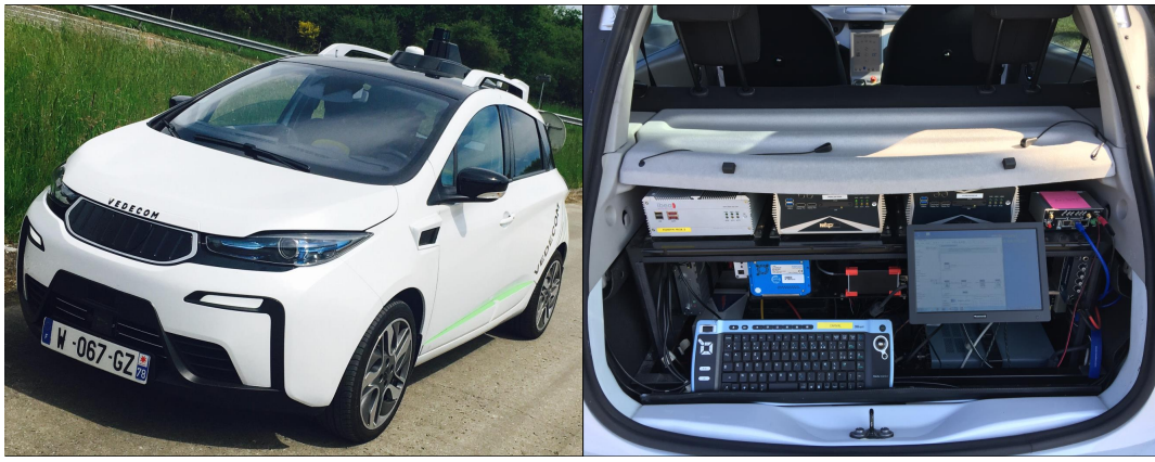
Figure 3: Démonstrateur VEDECOM : capteurs installés et plate-forme matérielle interne.
